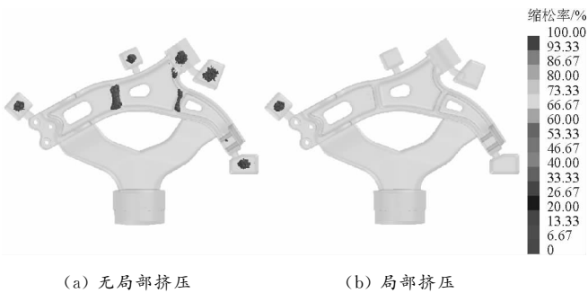
图 6 铸造过程的缺陷模拟分析结果
